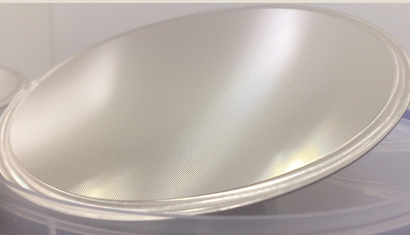
Bild 1. Nickelstempel mit einem Durchmesser von 120mm und einer Gesamtdicke von 1mm
