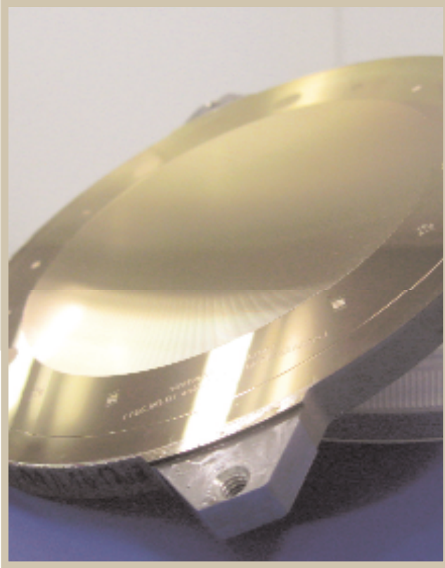
Bild 2. Hybrid Nickelstempel mit einem Durchmesser von 160mm und einer Dicke von 13mm
